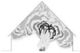
Rauch und Wärme sammeln sich an
